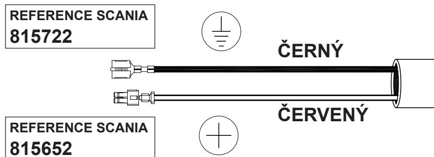
**13** Vložte červený/kladný kabel do pojistkové skříně.
