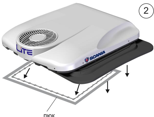
**3** Используя крутящий момент  $3,75 \text{ Н}\cdot\text{м} \pm 10\%$ , закрепите оборудование (16) самонарезающими винтами WN5451 ( $60 \times 20$ ) для пласти массы таким образом:
