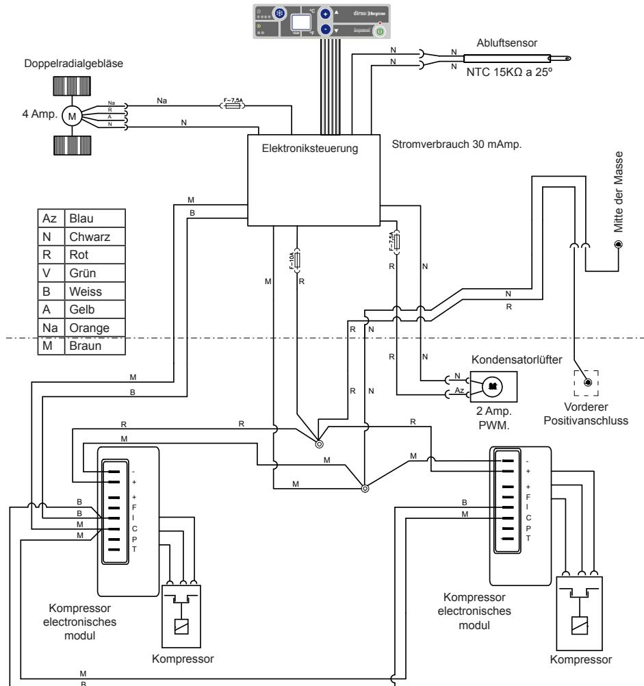
FAHRZEUGE MIT ORIGINAL-NETZKABEL- Elektroschema
