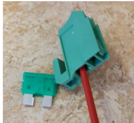
**14** На задней стороне блока питания установите держатель предохранителя с кабелем в нерабочем положении. Проверьте надежность фиксации. Спереди вставьте предохранитель с номинальным током 30 А.
