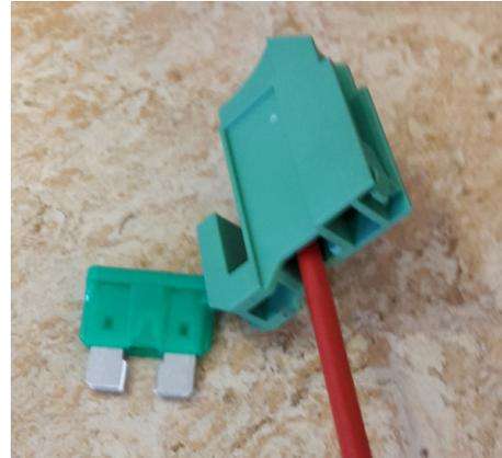
**14** Por el reverso de la caja fusibles, insertar el portafusibles con el cable en una posición vacía. Asegurarse de que encaje en su posición. Desde la parte frontal, insertar un fusible de 30 A.
