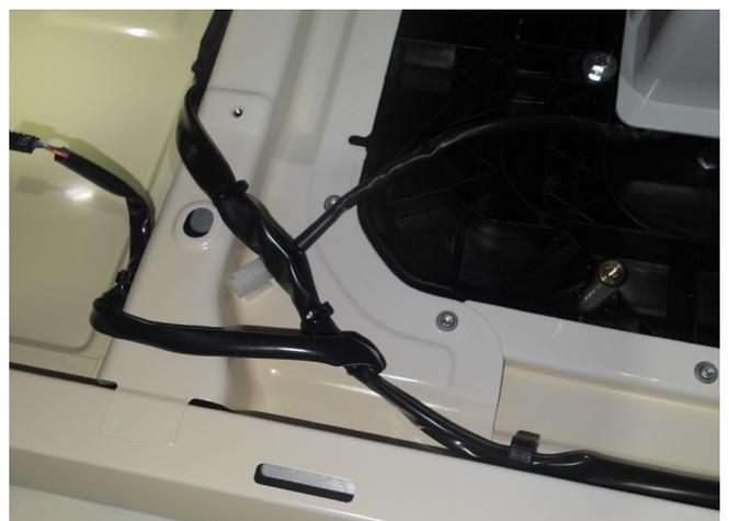
**6** Kably ved'te podél existujících kabelů po struktuře kabiny směrem k její pravé čelní části. Kabel uložte mezi boční panel a úložný prostor nad čelním oknem.
