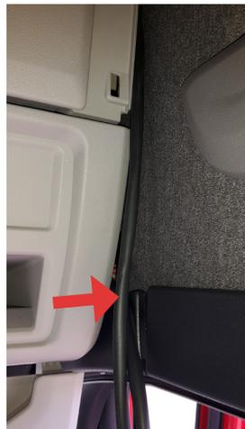
**7** En la cubierta de la columna A, retire el altavoz y el tornillo situado detrás del altavoz. A continuación, retire el panel.
