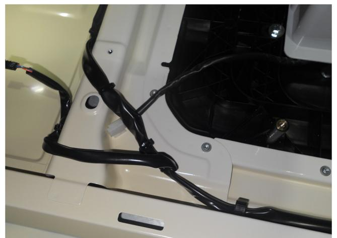
**6** Acheminer le câble le long des câbles existants et des structures dans la zone du toit vers la partie avant droite de la cabine. Positionner le câble entre le panneau latéral et le rangement au-dessus du pare-brise.
