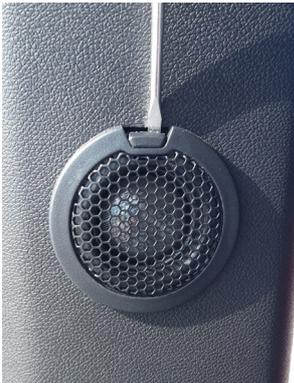
**8** Nell'area superiore del montante A, rimuovere la vite e allentare il pannello mostrato.
