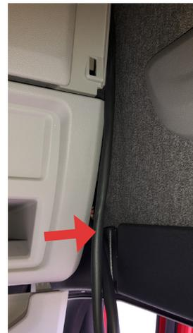
**7** Снимите с крышки передней стойки динамик и скрытый за ним винт. Затем снимите панель.
