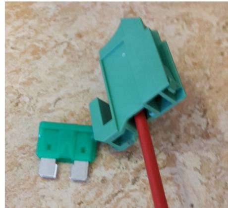
**14** Sul lato opposto della Centralina, inserire il portafusibile con il cavo in una posizione libera. Verificare che questo scatti in posizione. Dalla parte frontale, inserire un fusibile da 30 A.
