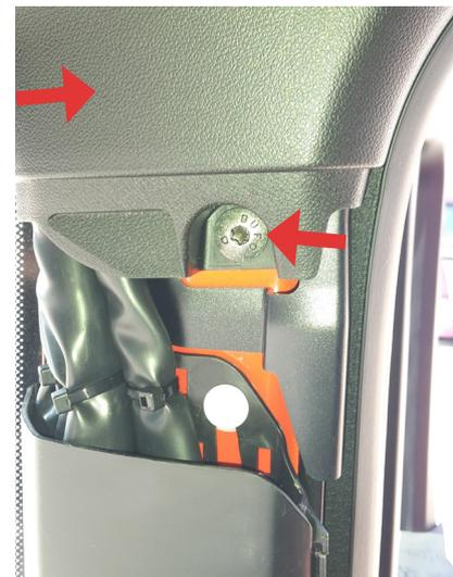
**9** Kabel in der A-Säulen-Verkleidung entlang der anderen Kabel verlegen.
