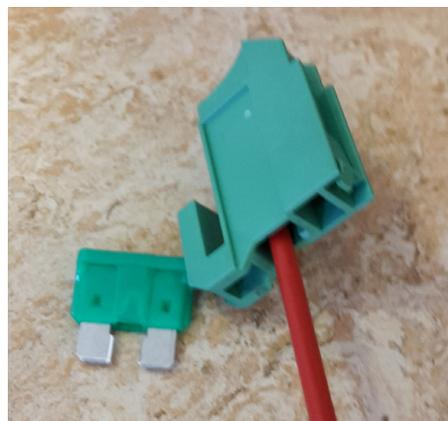
**14** Na zadní straně skříně s pojistkami vložte jednotku s kabelem do jedné z neobsazených přihrádek. Ujistěte se, že je správným způsobem usazená. Z čelní strany zasuněte pojistku na 30 A.
