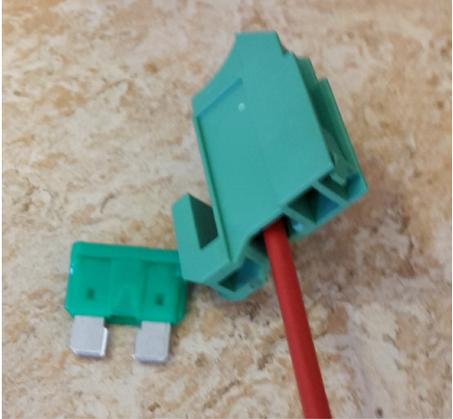
**14** Auf der Unterseite der zentralen Karosserieelektrik den Sicherungshalter mit dem Kabel in einen unbelegten Platz stecken. Vergewissern Sie sich, dass er in seiner Position einrastet. Auf der Vorderseite eine 30A-Sicherung einstecken.
