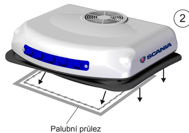
**3** Zařízení upevněte pomocí (16) vrtů do plastu WN5451 (60x20) při kroučícím momentem  $3,75 \pm 10\%$  Nm v následujícím pořadí:
