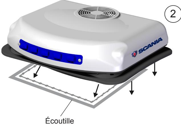
**3** Fixer l'équipement avec (16) vis filetées en plastique WN5451 (60x20) avec un couple de serrage de  $3,75 \pm 10\%$  Nm, en respectant l'ordre suivant :
