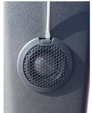
**8** Dans la partie supérieure du pilier A, retirer la vis et desserrer le panneau illustré.
