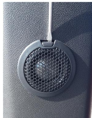
**8** Снимите винт в верхней части стойки и ослабьте крепление указанной панели.
