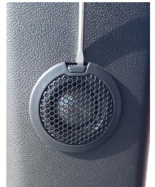
**8** Im oberen Bereich der A-Säule die Schraube abnehmen und die gezeigte Verkleidung lockern.
