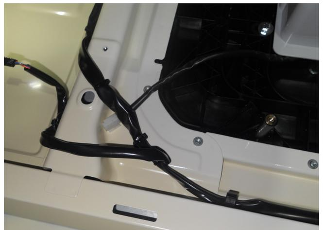
**6** Прокладывайте кабели вдоль существующих кабелей и конструкций на крыше по направлению к передней правой части кабины. Проведите кабель между боковой панелью и отсеком хранения над ветровым стеклом.
