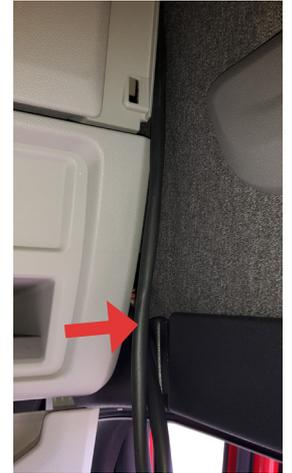
**7** Auf der A-Säulen-Verkleidung den Lautsprecher und die dahinterliegende Schraube abnehmen. Dann die Verkleidung entfernen.
