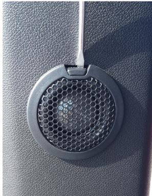
**8** En la parte superior de la columna A retire el tornillo y afloje el panel mostrado.
